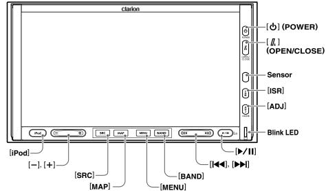
With the operation panel open / Avec le panneau de commande ouvert / Con el panel de funcionamiento abierto
